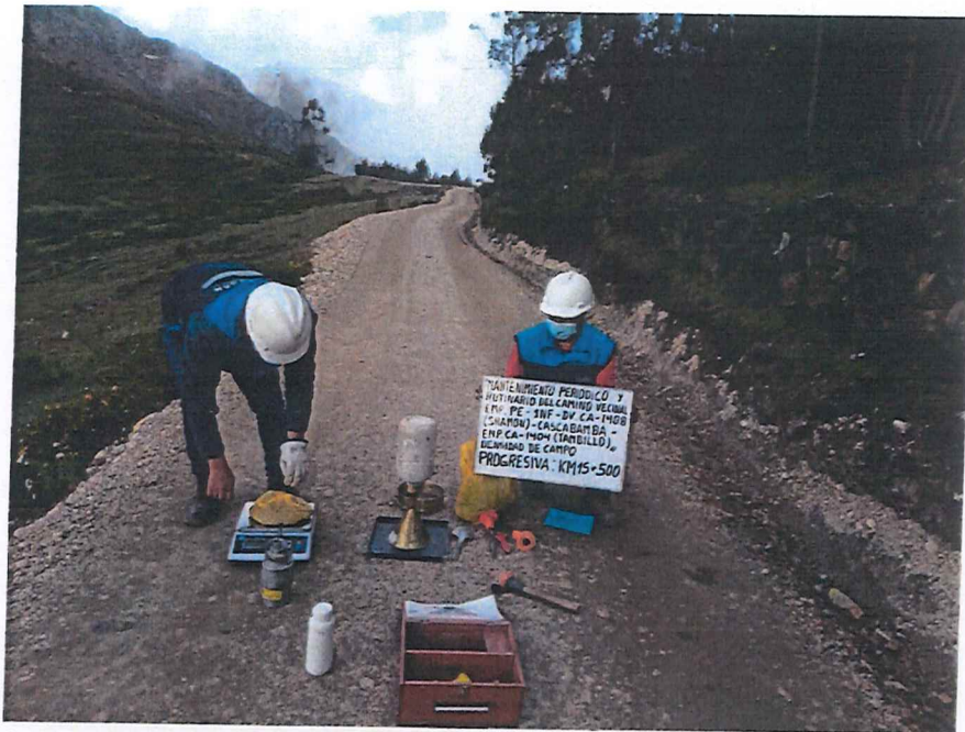
FIGURA N° 63. Ensayo de Densidad de Suelo en Campo. Progresiva 15 + 500 (Método del cono de arena).
