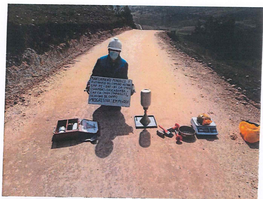
FIGURA N° 57. Ensayo de Densidad de Suelo en Campo. Progresiva 14 + 000 (Método del cono de arena).
