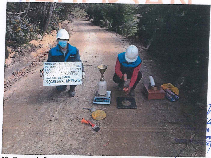
FIGURA N° 58. Ensayo de Densidad de Suelo en Campo. Progresiva 14 + 250 (Método del cono de arena).
