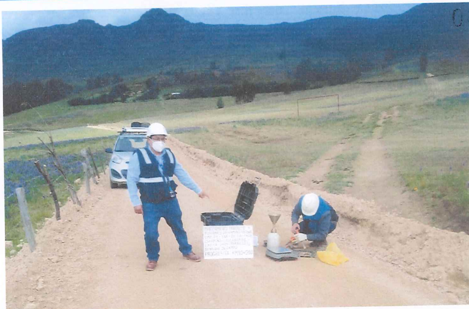
SE OBSERVA AL INSPECTOR DEL SERVICIO VERIFICANDO LA OBTENCION DE MUESTRAS PARA REALIZAR LA DENSIDAD DE CAMPO, SEGÚN LO INDICADO EN EL PLAN DE TRABAJO.
