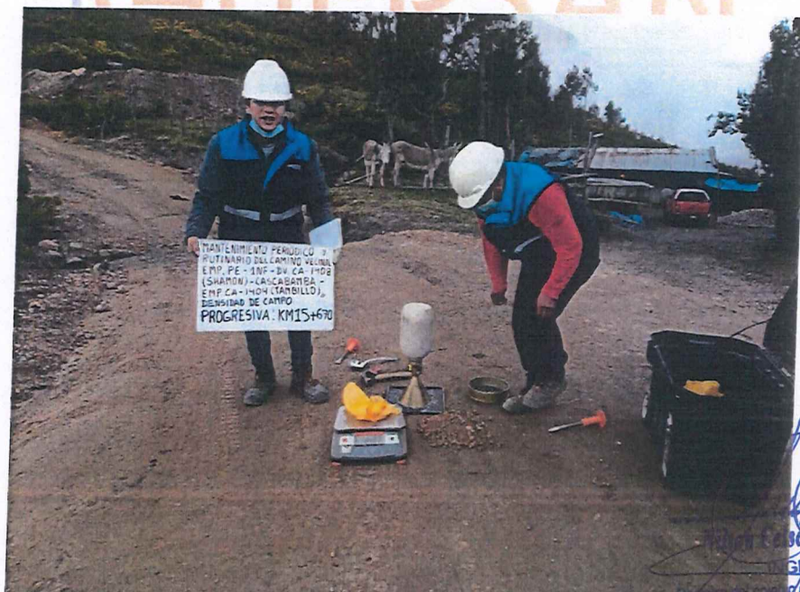
FIGURA N° 64. Ensayo de Densidad de Suelo en Campo. Progresiva 15 + 670 (Método del cono de arena).
