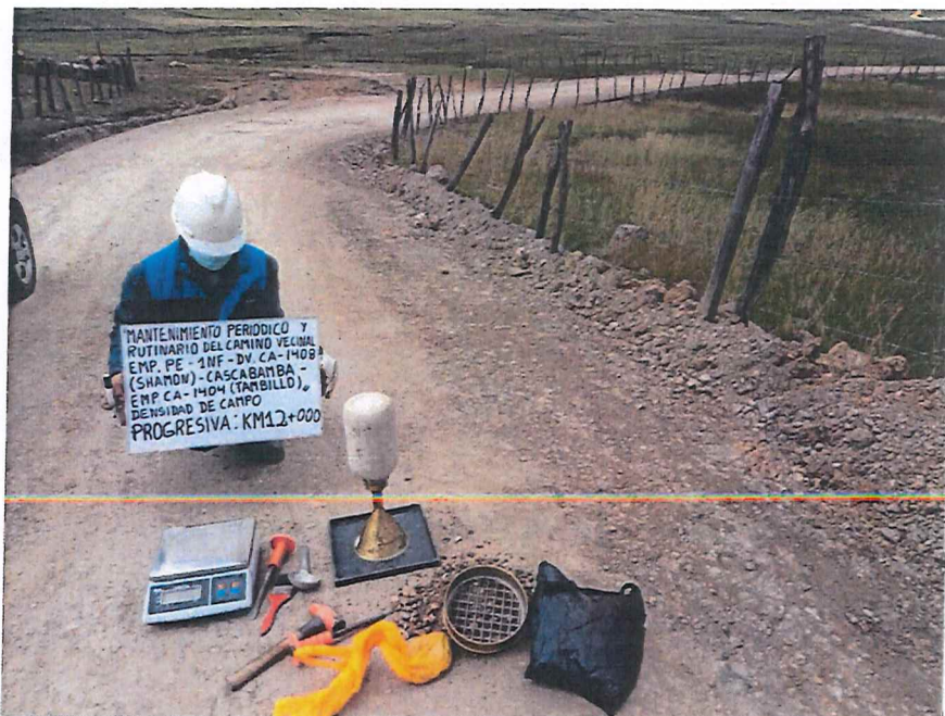
FIGURA N° 49. Ensayo de Densidad de Suelo en Campo. Progresiva 12 + 000 (Método del cono de arena).
