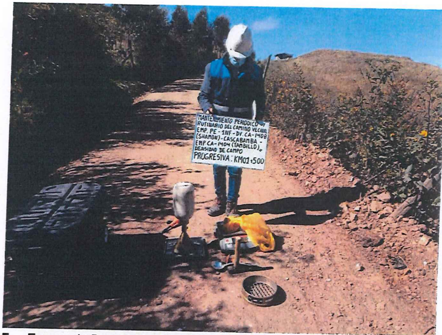
FIGURA N° 7. Ensayo de Densidad de Suelo en Campo. Progresiva 01 + 500 (Método del cono de arena).
