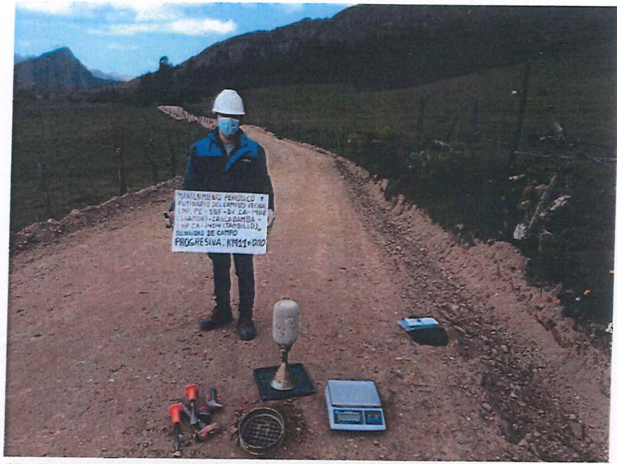
FIGURA N° 45. Ensayo de Densidad de Suelo en Campo. Progresiva 11 + 000 (Método del cono de arena).
